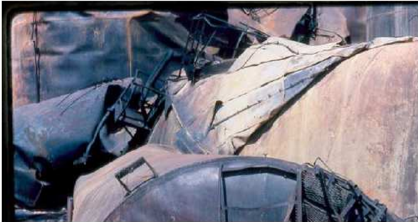
Figure 12. Bac d'hydrocarbure à la suite d'une explosion interne
